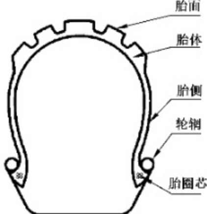
图 3 钩边(HB)轮胎断面
